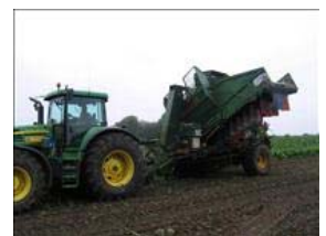
Med en helplanteroptager (Thyregod) kan både rod og top høstes i en arbejdsgang og samensileres med et saftopsugende fodermiddel som majs. Foto: Karsten A. Nielsen
